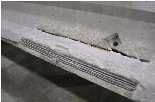
شکل ۳- خسارت شبه ضربه ای در نمونه تیر بتنی پیش تنیده
